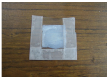
圖 12 用美工刀割除玻璃以外的膠帶
