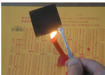
圖 9 於蠟燭的火焰上燒烤以製作碳電極
