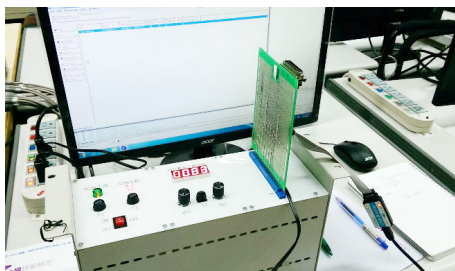
圖 8 燒錄程式至晶片並利用測試電路
